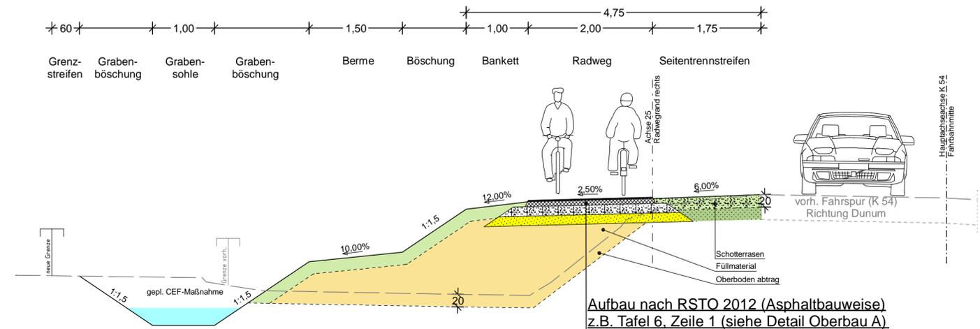
Aufbau nach RSTO 2012 (Asphaltbauweise)
