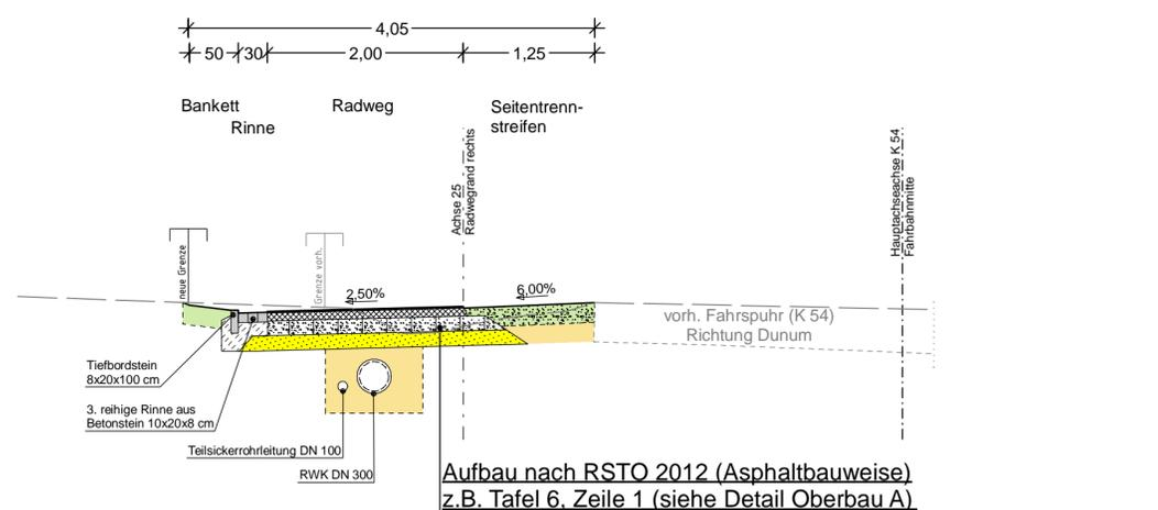
**Regelquerschnitt 6** selbstständig geführter Radweg hinter vorh. Grabenfeld (z.B. Station 2+520)
