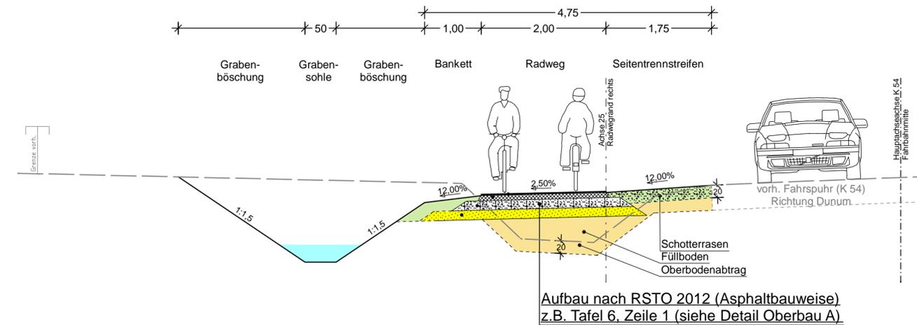
**Regelquerschnitt 2** straßenbegleitender Radweg mit Muldenentwässerung (z.B. Station 1+330)
