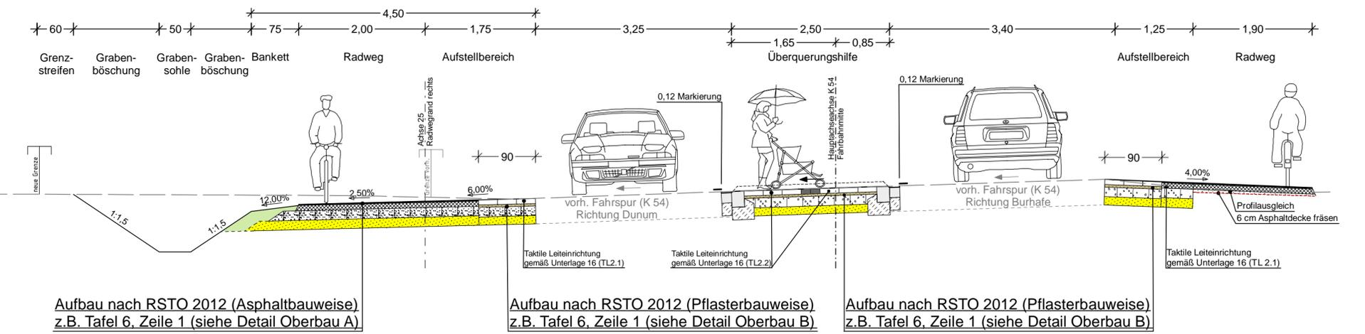
Aufbau nach RSTO 2012 (Asphaltbauweise)
