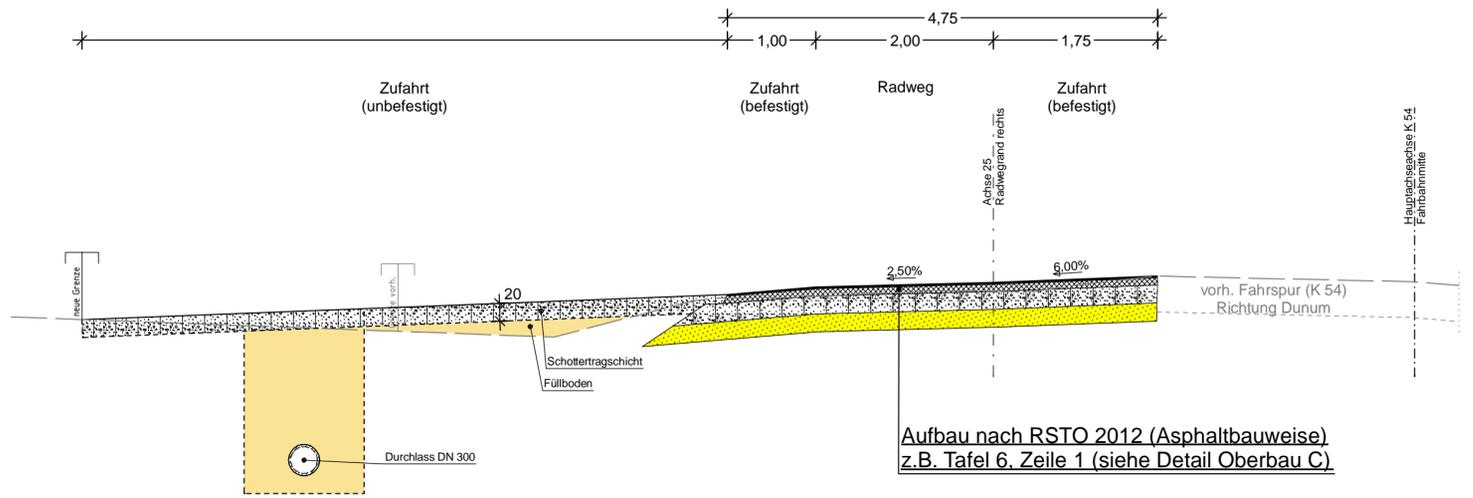
Aufbau nach RSTO 2012 (Asphaltbauweise)
