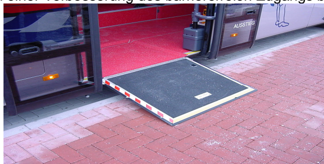
Abbildung: A - 9, Rampe zur Verbesserung eines barrierefreien Ein- und Ausstiegs
